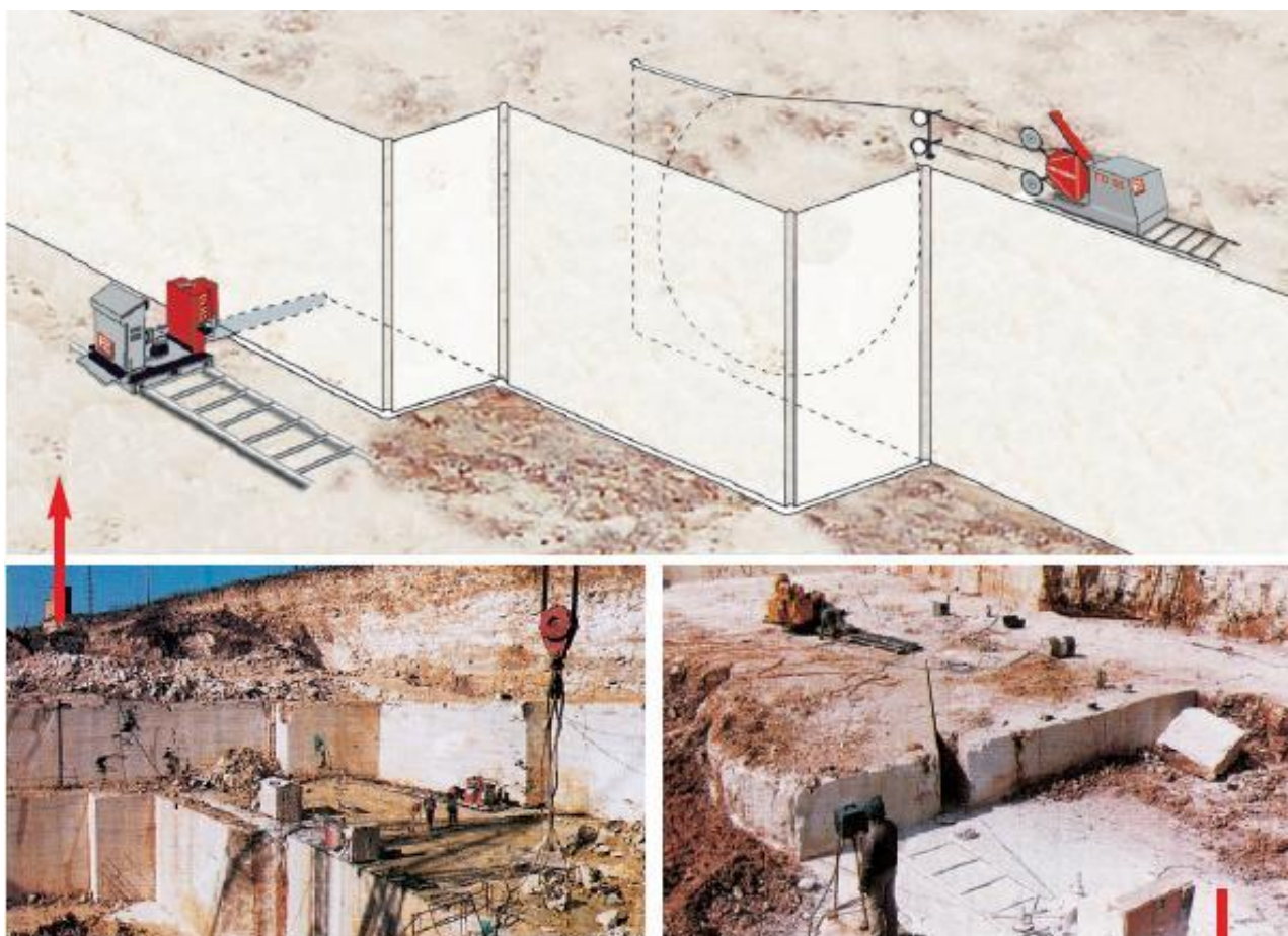
Фиг.1 Общ вид на комбинираната технология за добив верижна каменорезна машина – “диамантена” въжена резачка
