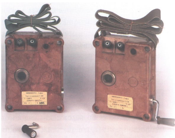
Фиг. 2 Общ вид на взривни машини тип Лазаров с ключ и бутон
