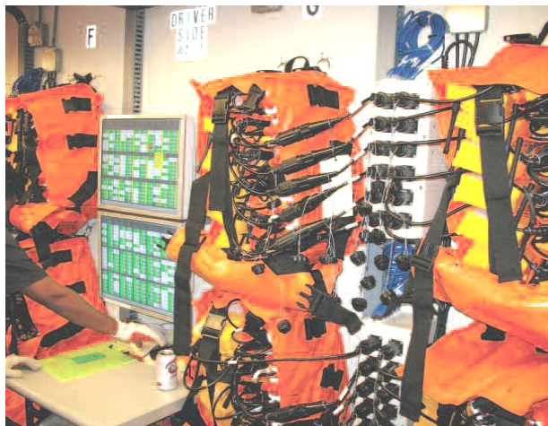
Фиг. 5. На фигурата са показани раниците, съдържащи системата FireFly и векторно-сеизмичните приемници
