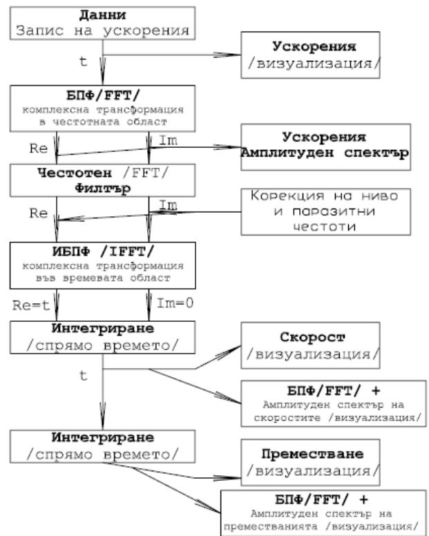
Фиг. 8. Блок схема на методиката за обработка на сигнали и визуализация на резултати .
