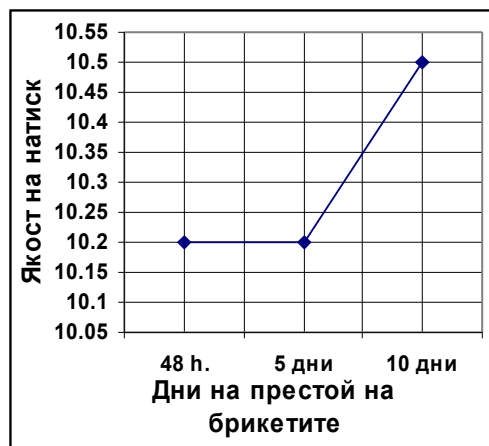
Фиг. 6. Влияние на времето на престой върху якостта на брикети произведени с 10,0% декстринов разтвор при разход 18,0%, класа въглища 2-0 mm.
