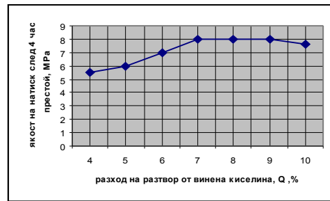
Фиг. 3. Зависимост между количеството винената киселина (под формата на 10,0% воден разтвор) и якостта на натиск на брикети изследвана след 4 часов престой при температура 15°C и постоянен разход на талов пек 6,0%
