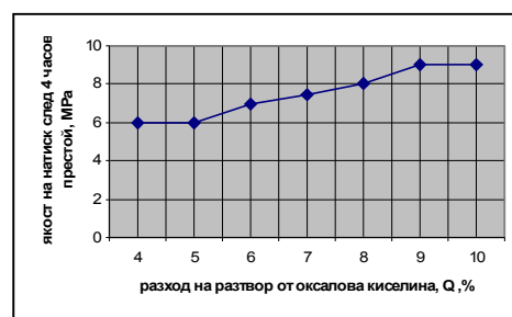
Фиг. 5. Зависимост между количеството оксаловата киселина (под формата на 10,0% воден разтвор) и якостта на натиск на брикети изследвана след 4 часов престой при температура 15°C и постоянен разход на талов пек 6,0%
