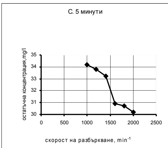
Фигура 5. Влияние на скоростта на разбъркване върху окислителните процеси във флотационния пулп при плътност на пулпа 50% тв.
