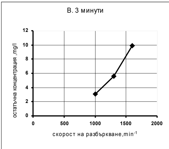
Фигура 7. Десорбция на диксантогенат от минералната повърхност в плътен пулп с повишена скорост на разбъркване при плътност на пулпа 40% тв.
