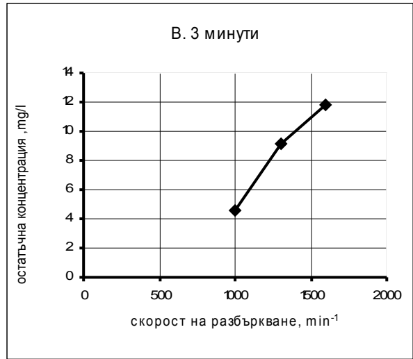
Фигура 8. Десорбция на диксантогенат от минералната повърхност в плътен пулп и повишена скорост на разбъркване при плътност на пулпа 50% тв.
